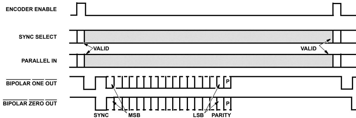
FIGURE 4. ENCODER TIMING
