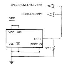
OSCILLOSCOPE: TEKTRONIX 468 SPECTRUM ANALYZER: HP 3585A
