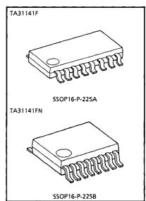
Weight SSOP16-P-225A: 0.14g (Typ.) SSOP16-P-225B: 0.07g (Typ.)
