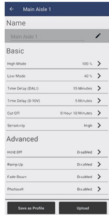
Example of parameters for 01-10V wiring
