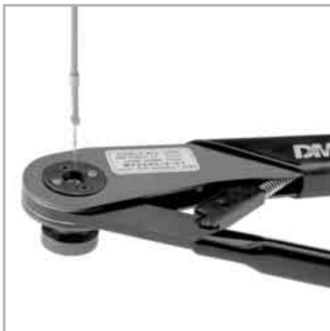
Crimping des Innenleiters mit der Handcrimpzange M22520/2-01 . Crimping the inner conductor with hand cimp tool M22520/2-01 .
