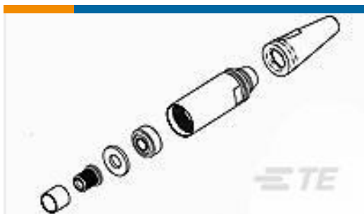
TE Model / Part #1828700-1 CBL ADPT,PRO BEAM MINI PLUG 5.0 AL EPDM
